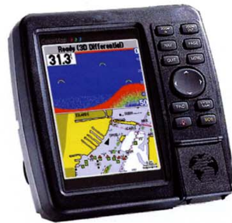
Esempio di GPS cartografico a colori da plancia integrato con ecoscandaglio
