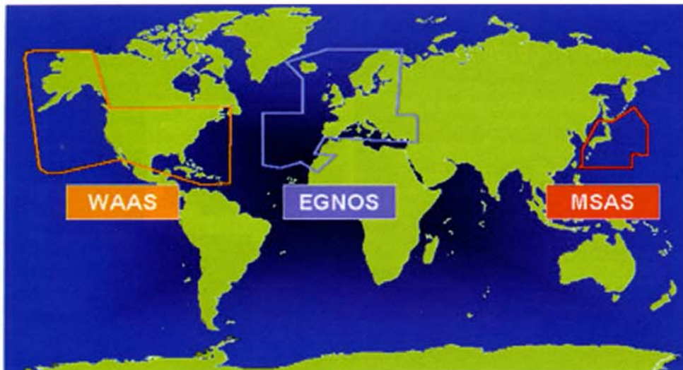
Are di copertura dei sistemi differenziali americano (WAAS), europeo (EGNOS) e giapponese (MSAS). Immagine ESA - European Space Agency ( http://www.esa.int/ )
